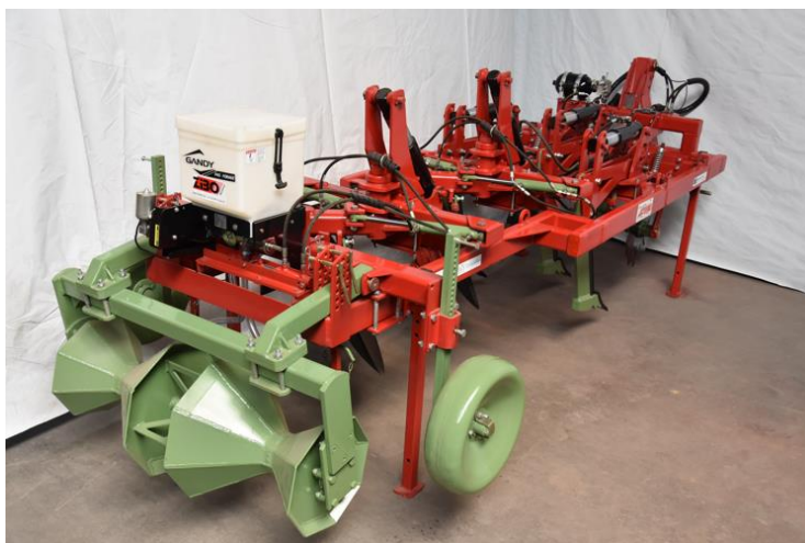
Groasis Terracedixx sème immédiatement des grains d'herbes sur les terrasses.
